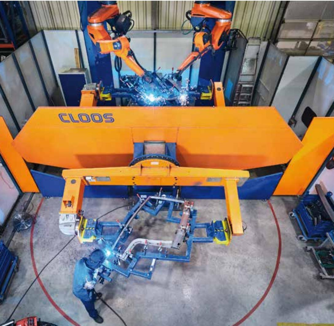
Schweißroboter für Schweißbauuntergruppen, z.B. Seitenwände
