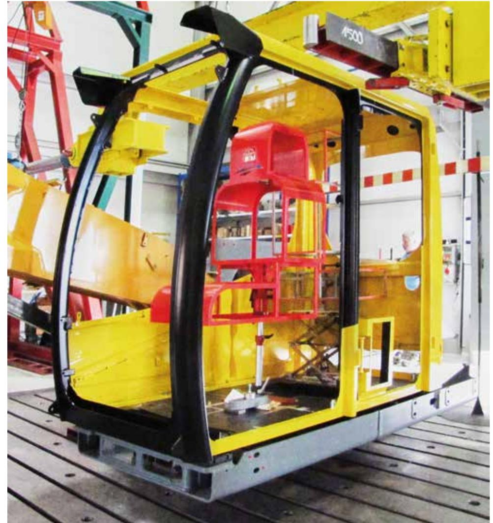
ISO Test für ROPS-/FOPS-Sicherheitsstrukturen
