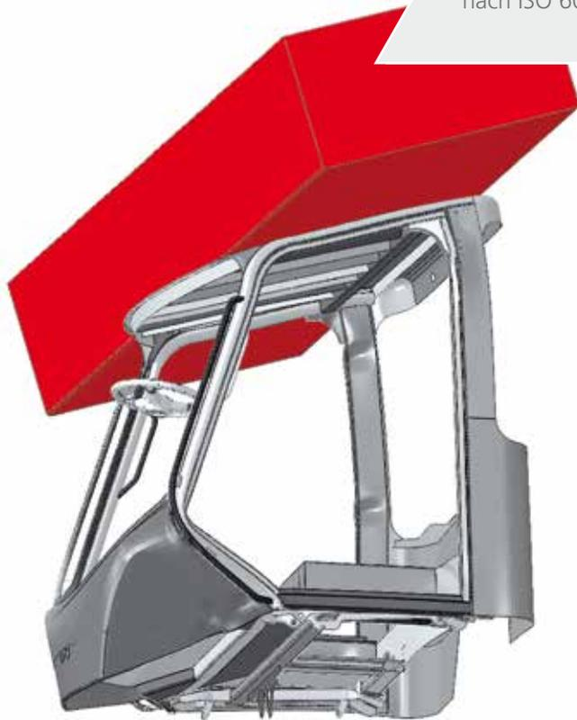
FEA (Finite Elemente Analyse) für Sicherheitsstrukturen
