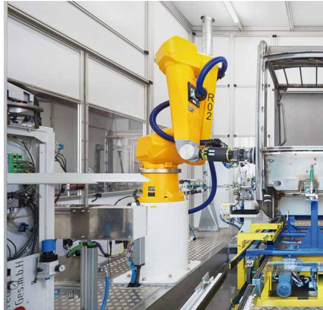
Vollautomatisierte Roboterschleifzelle für Kabinen
