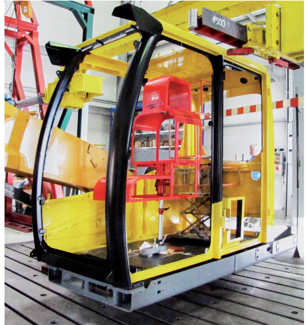
ISO Test für ROPS-/FOPS-Sicherheitsstrukturen
