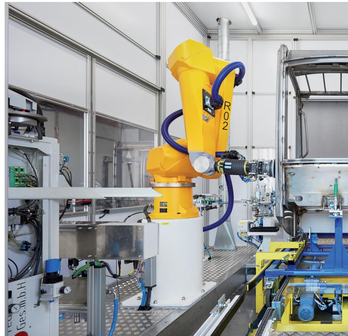
Vollautomatisierte Roboterschleifzelle für Kabinen
