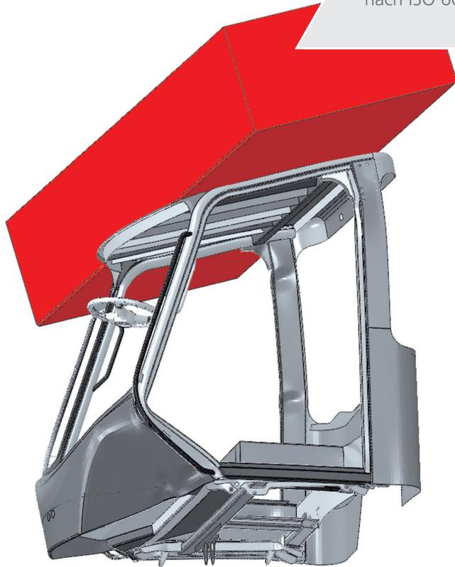
FEA (Finite Elemente Analyse) für Sicherheitsstrukturen
