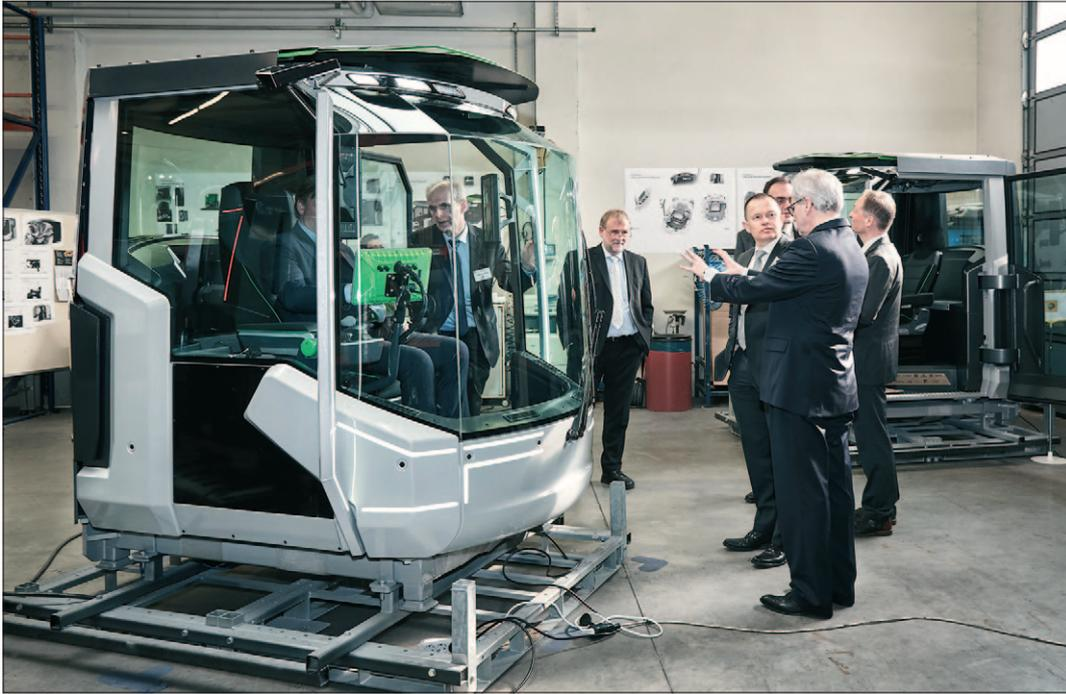
Die Genius Cab hat einen modularen Aufbau mit einer sogenannten „SoftCab“ aus verschweißten Aluminium-Spezial-Profilen und dem EXO-ROPS/FOPS, der zusätzlich über der Kabine montiert ist.
